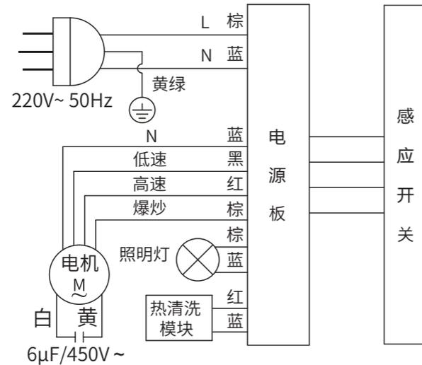
图4 CXW-260-TA02吸油烟机电气原理图
