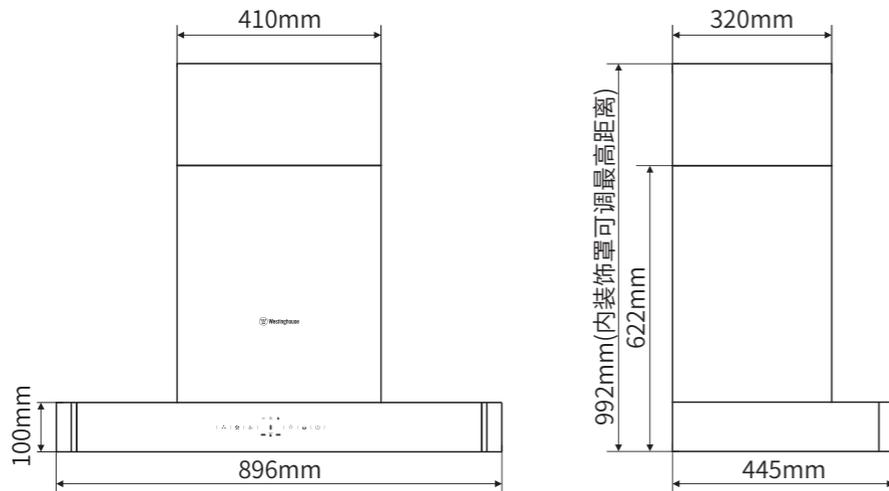
图1 CXW-260-TA02吸油烟机外形尺寸图
