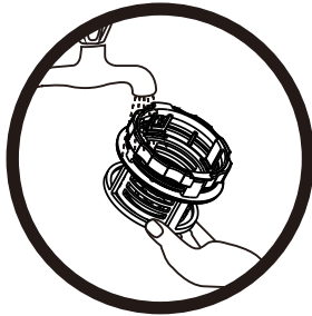
用水冲洗时，可以用软毛刷 清洗，不得使用钢丝球等铁 制品清洗，以免损坏过滤器
