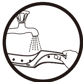
用流动水冲洗 清理干净后装回原位
