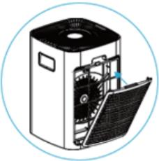
重新安装侧面板，先将面板安装到产品底部。然后，轻推面板。
