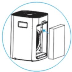
将拆去包装的空气净化滤网放回产品内。
