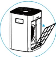
向下按两个固定夹，然后朝向您自己的方向拉动预过滤网。
