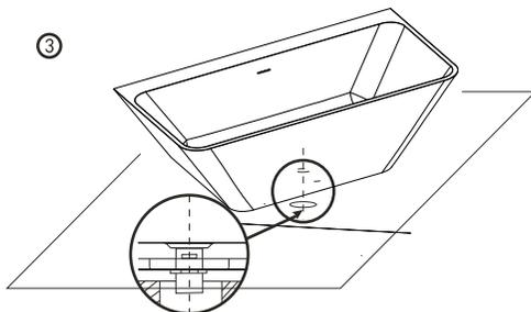
3. 把安装好去水器的浴缸抬起或移动让去水器出口进入下水道在地板上, 小心不要让去水器出口触摸和撞到地板上。
