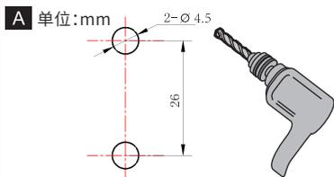
根据图示位置尺寸, 在墙上合适位置钻两个直径为4.5mm的孔, 深度>20mm。
