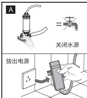
第一步:关闭球阀开关,拔出电源插头
