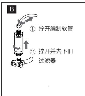
第二步:拧开编制软管及过滤器,放空内部的水。
