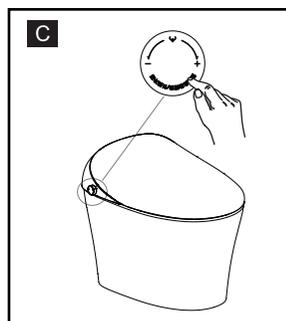
第三步:长按按钮,将管路内部残留水排除。
