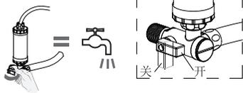
调节球阀, 使产品在合适水量下工作。顺时针方向降低水量, 逆时针方向增加水量。
