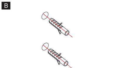
将配件包内的膨胀螺母装入钻好的孔内。
