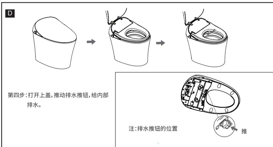
第四步:打开上盖,推动排水推钮,给内部排水。
