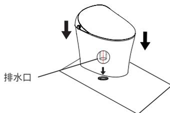
将陶瓷排水口对准PVC排水管,用力下压,至一体机的陶瓷与地面平齐。
