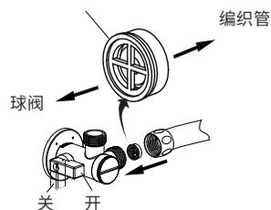
当安装进水压力约大于0.2MPa时,请安装配件包配送的限流片。
