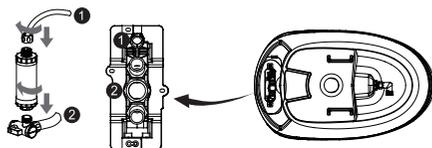
按照图示的数字标识,对应安装好供水软管和过滤器,接入电子盖的用水需接过滤器。
