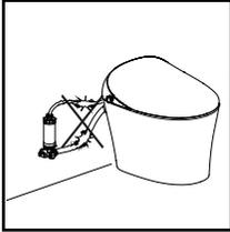
安装时,必须使用随机带的新软管组件,旧软管组件不能重复使用。切勿弯曲或扭曲进水管软管。(否则可能导致漏水或产品性能下降。)
