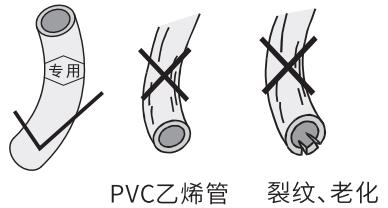
2、胶管的一端套入灶具进气接头至红线处，连接处用卡箍箍紧，防止漏气，另一端接气源总阀胶管不要置于灶面上，且胶管不得受压、硬性折弯等。
