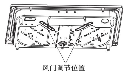
● 握住风门调节手柄，抬起1mm左右后再向左或右拨动。手柄向右拨动时，调小风门进风口，空气进入量减少，手柄向左拨动时，调大风门进风口，空气进入量增大。
